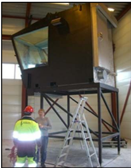
Da var krancabinen trygt på plass på pidestallen. Et mektig syn når vi tar et par steg tilbake for å betrakte det hele. Nå starter monteringen av selv kula / doomen som skal omringe selve krancabinen.
